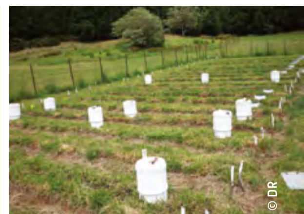
Sur cette parcelle de prairie de la Sicalait, les enceintes blanches mesurent les émissions de gaz à effet de serre.
